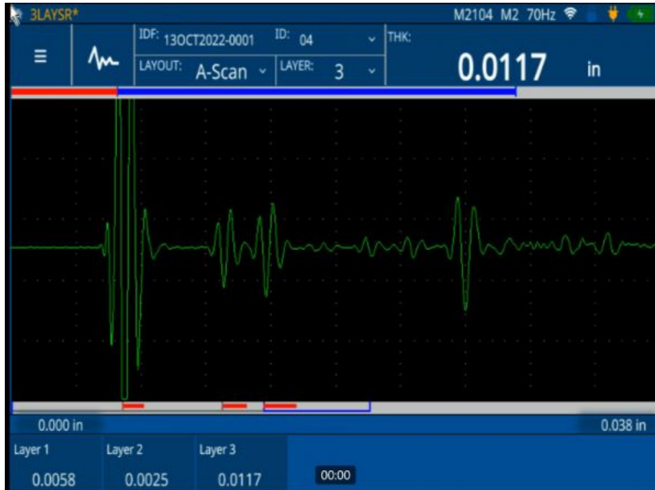
72DL PLUS Ultraschall-Dickenmesser bei einer 50-MHz-Messung eines dreischichtigen Kunststoffbehälters
